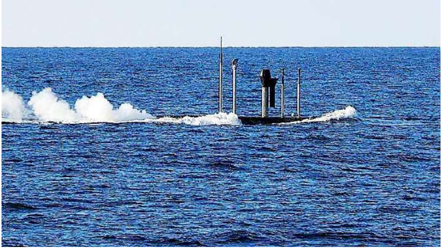
Подводная лодка идёт под РДП (над водой выдвигающиеся устройства, виден шлейф выхлопных газов от работающего дизеля – современный снимок)
